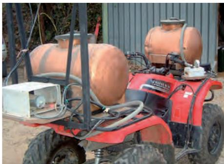
*Квадроцикл оснащен медными резервуарами и роторным мембранным насосом.*
