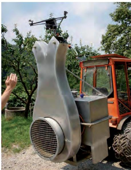
*Турбинный опрыскиватель для "роговой кремнезёма" (501) и форсунки, позволяющие опрыскивать большими каплями под низким давлением для "рогового коровьего навоза" (500 или 500P) с помощью осциллирующего устройства (на основе механизма стеклоочистителя).*
