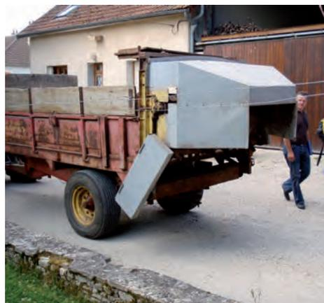
*Разбрасыватель, оснащенный дефлектором для формирования небольших компостных куч (Винсент Даувиссат (Vincent Dauvissat)).*
