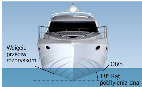
Kadłub V w żegludze w trybie wypornościowym
