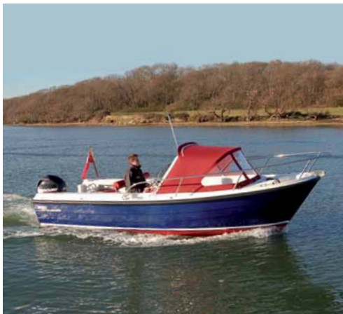
Kadłub ślizgowy w trybie wypornościowym
