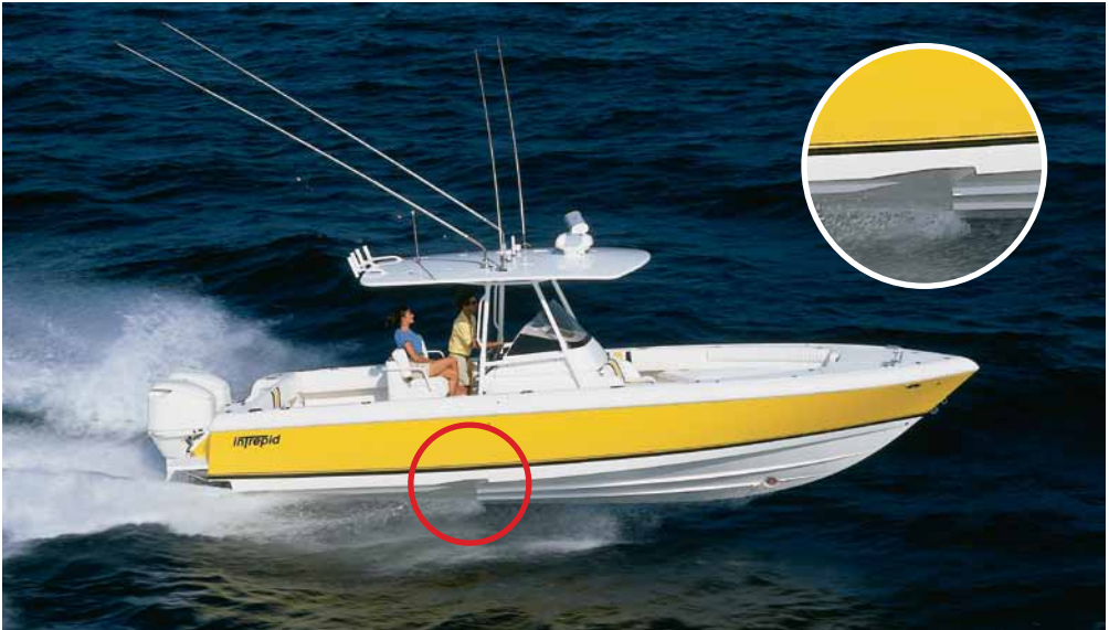
Sportowa wędkarska łódź Intrepid z napowietrzonym kadłubem. Powietrze jest zasysane przez uskok w kadłubie, zmniejszając jego powierzchnię zmoczoną i opór
