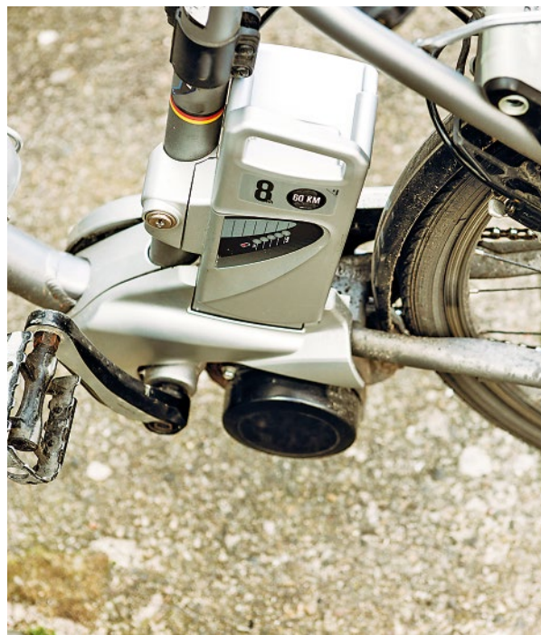
Rower elektryczny. Na zdjęciu widać silnik (czarna obudowa) i akumulator z elektroniką (obudowa szara)
