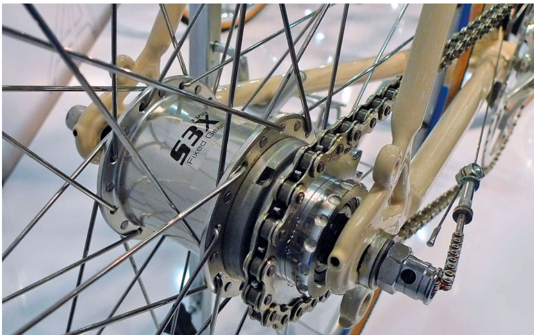
Współczesna piasta z przekładnią planetarną. Po prawej widać łańcuszek i linkę, za pomocą których odbywa się zmiana biegu
