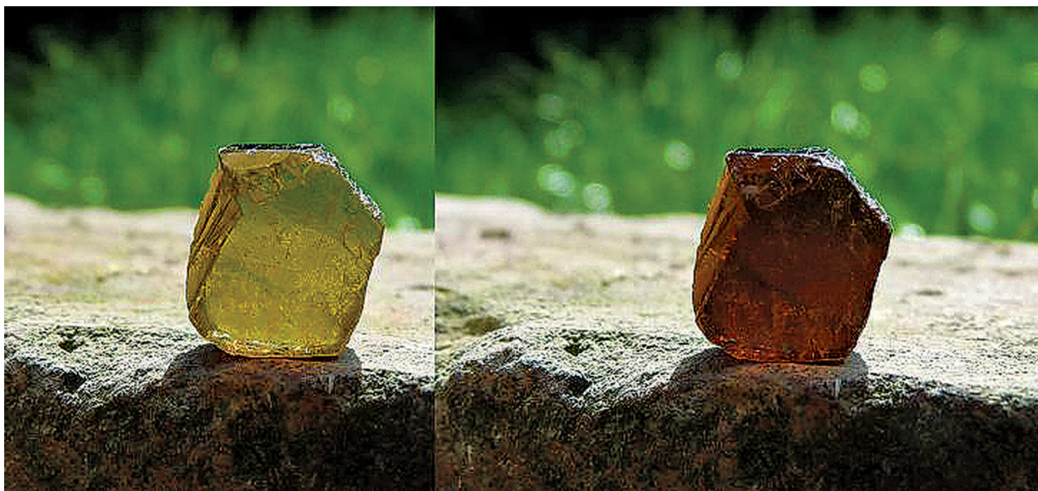
Pleochroizm turmalinu (fotografia w świetle naturalnym i spolaryzowanym)
