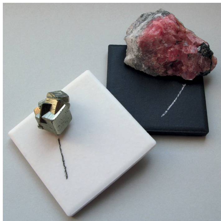
Różne barwy rysy (po lewej pirit, po prawej rodochrozyt)
