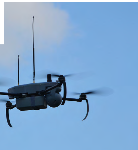
Główne zadanie systemu bezzałogowego Virtus, to rozpoznanie optyczne prowadzone z wykorzystaniem kamery światła dziennego lub kamery termowizyjnej, przede wszystkim w terenie zurbanizowanym. Fot. Maciej Szopa
