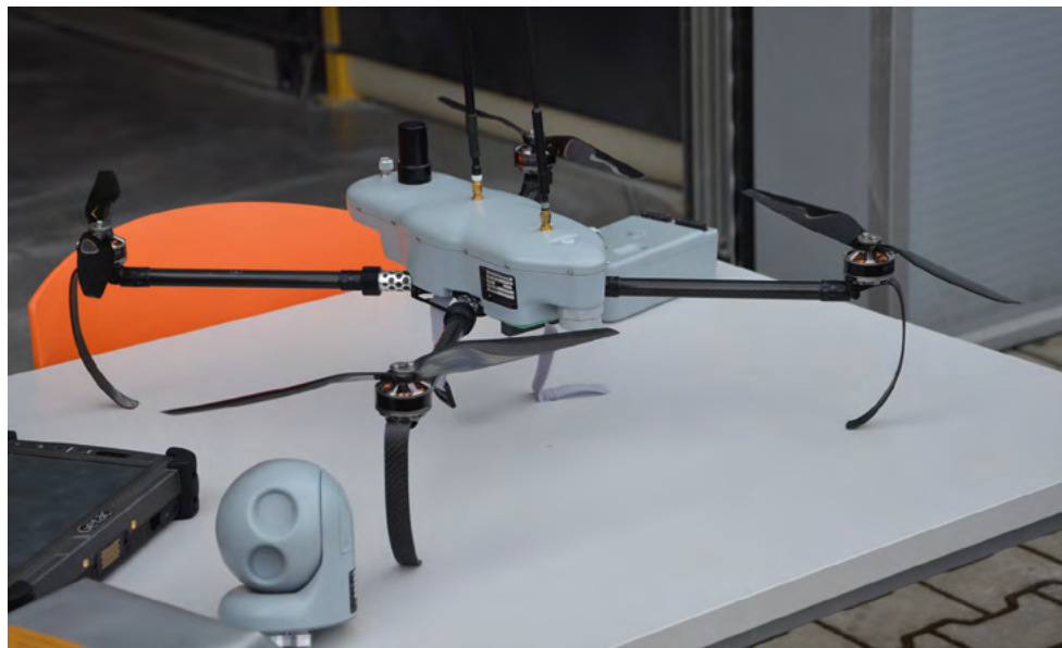
Zestaw Virtus to kandydat WB Electronics Group na rozpoznawczy mini-bezzałogowy system powietrzny „Ważka”. Na zdjęciach kolejno: aparat latający zestawu ze zdemontowaną modułową optoelektroniczną głowicą obserwacyjną, Virtus w locie i konsola kierowania i kontroli lotu aparatu. Fot. Maciej Szopa
