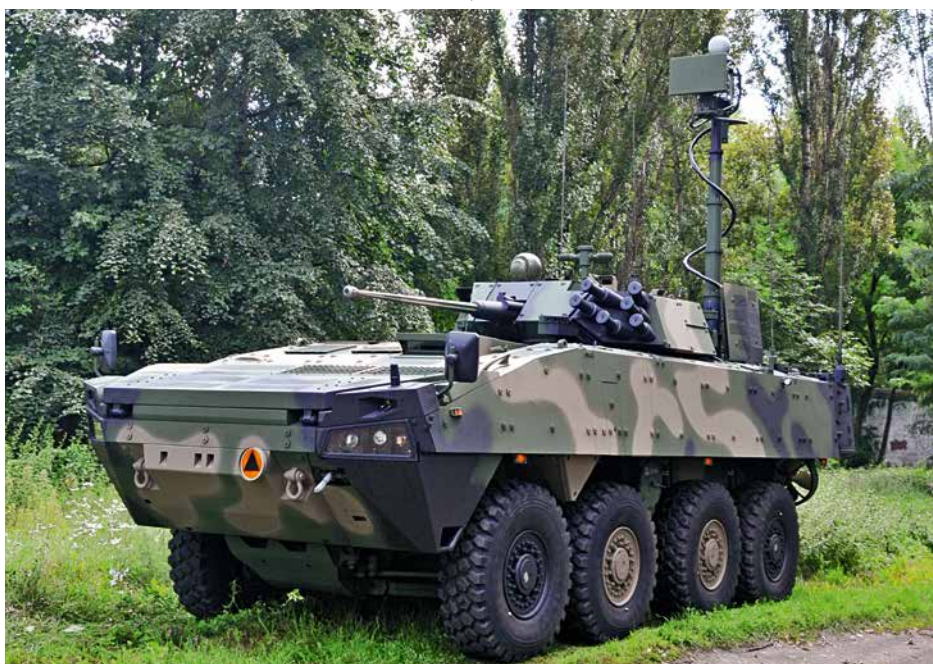
Prototyp wozu rozpoznania ogólnowojskowego w wersji dowódczo-rozpoznawczej R-1 (WDR). Pojazd w położeniu bojowym, z podniesionym masztem ze stacją radiolokacyjną i głowicą optoelektroniczną. Zdjęcie wykonano w sierpniu 2016 r., tuż po skompletowaniu wozu i przed jego jedyną, jak dotąd, publiczną prezentacją podczas XXIV MSPO w Kielcach.
