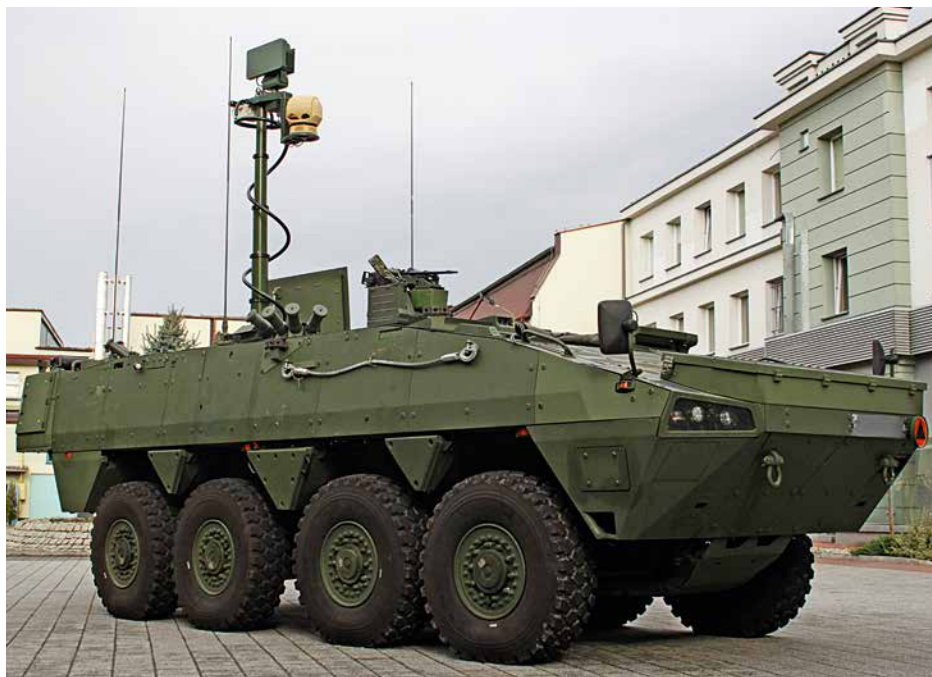
Niedawno ukończony prototyp Artyleryjskiego Wozu Rozpoznawczego na podwoziu Rosomak 8x8 (Rosomak-AWR) z wysuniętym masztem z wyposażeniem rozpoznawczym, wchodzącym w skład Pokładowego Zestawu Obserwacyjno-Rozpoznawczego (PZOR).
