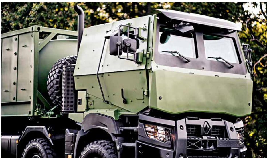
Nowa integralnie opancerzona kabina z wymiennymi panelami poszycia ma bardzo charakterystyczny wygląd. Dlatego auta w nią wyposażone są bardzo łatwe do wizualnej identyfikacji.
