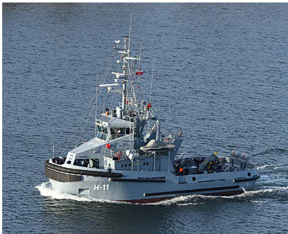
11 stycznia 2020 r., Bolko wchodzi po raz pierwszy do Świnoujścia. Sylwetka holownika jest bardzo nowoczesna. Uwagę zwracają anteny licznych urządzeń nawigacji, obserwacji i łączności na maszcie, tórz robocza, stelaż z dodatkowymi tratwami na rufie i docelowy układ odbijaczy na burtach.
