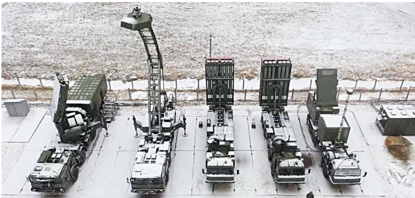
Elementy rakietowego systemu przeciwlotniczego S-350 pokazane w lutym 2020 r. w Gątczynie, od lewej: stacja radiolokacyjna 96L6-CP, stacja pasywnego systemu lokacji 96L6-WP, dwie wyrzutnie 50P6 i baterijna stacja 50N6 (mają być dwie na baterię). Poza kadrem jest stanowisko dowodzenia 50K6.
