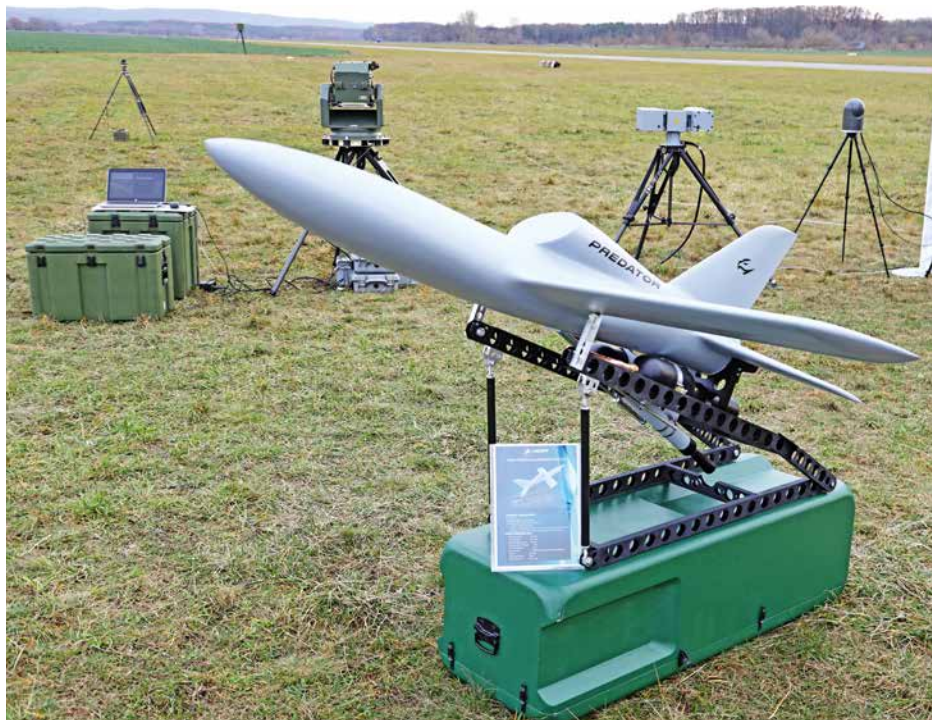
Makieta bezzałogowego aparatu latającego Predator AX-2 na wyrzutni, ustawionej na kontenerze transportowym zestawu. W tle znajdują się inne elementy systemu PUZZLE (od lewej) – kontenery transportowe, laserowy detektor skażeń chemicznych Falcon 4G, głowica optoelektroniczna MIRA, kontrolna głowica optoelektroniczna. W oddali widoczny radar trójwspółrzędny.
