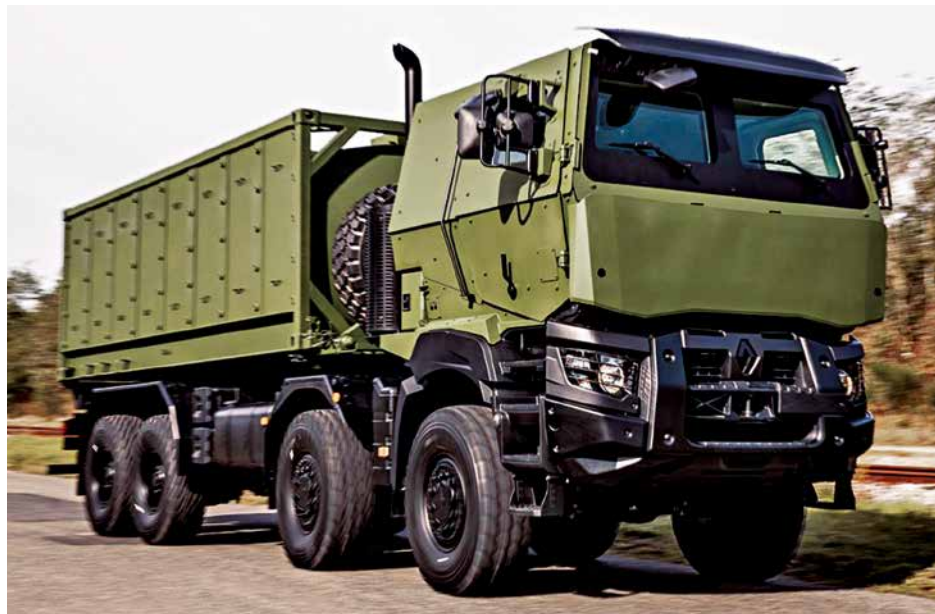
Czterosiowy ciężki transporter wsparcia logistycznego Arquus K8x8 z integralnie opancerzoną długą kabiną-kapsułą. Pojazd ten ujawniono pod koniec ubiegłego roku.
