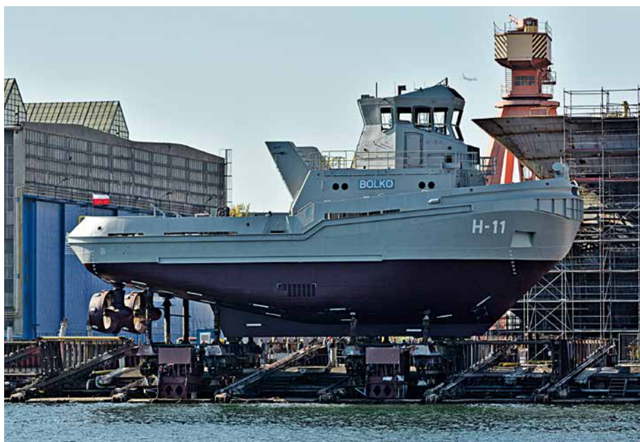
Bolko tuż przed wodowaniem. Widać pedniki azymutalne, typową dla holowników ASD stępkę skrzynkową przechodzącą w skeg na rufie, kratki chłodnicy skrzynkowej i miejsca montażu pierwotnych odbojnic. Górna ciągnęła się od rufy niemal na dziób, boczna była na linii wodnej. Obecnie układ ten skorygowano. Kominy są na wysokości okrężnie oszklonej sterówki, a spaliny z nich mogą w niektórych sytuacjach zakłócać widoczność.
